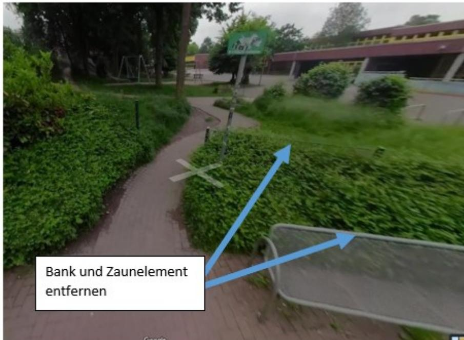
Die Bank, das Zaunelement und das Strauchwerk werden in diesem Bereich entfernt. Der Schilderpfosten versetzt. Die Banketten werden entsprechend hergerichtet.
