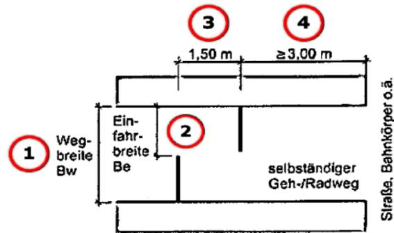
Abmessungen an Umlaufsperrn (Gitter ohne Überlappung anordnen)
