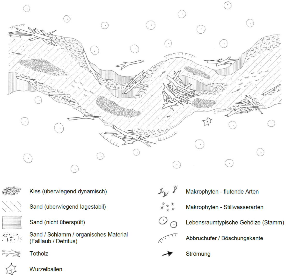
Abbildung 30: Beispielhafte Habitatskizze für die hydromorphologische Ausprägung des Kernlebensraums des FG-Typs 14 im guten ökologischen Zustand [DÖBBELT-GRÜNE ET AL. 2013]
