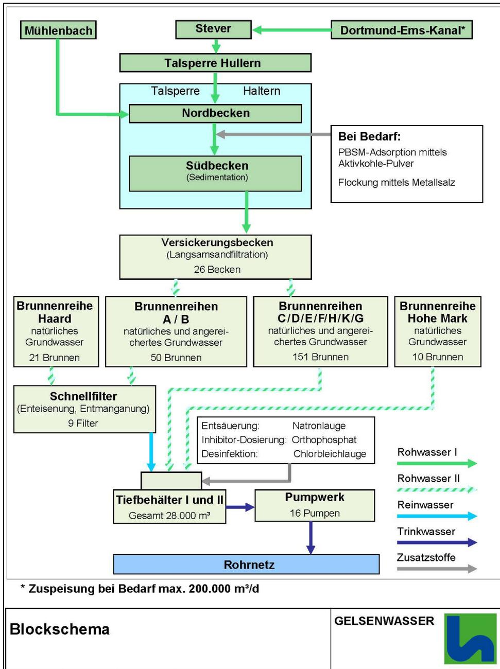
Abbildung 8: Blockschema der Betriebsweise des Wasserwerks Haltern
