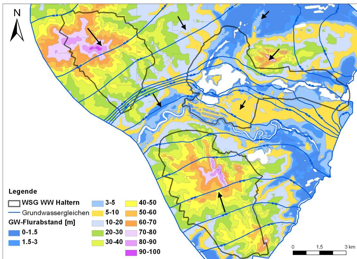
Abbildung 13: Grundwasserflurabstände und -fließrichtungen in den Wassergewinnungen
