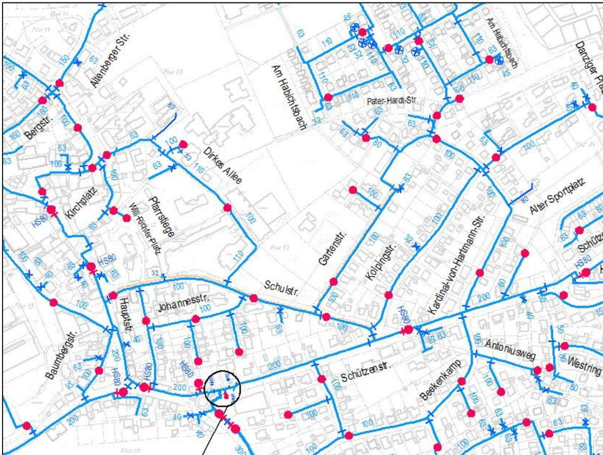
Abbildung 25: Ausschnitt Hydranten-Plan in Havixbeck (rote Punkte: Hydranten)
